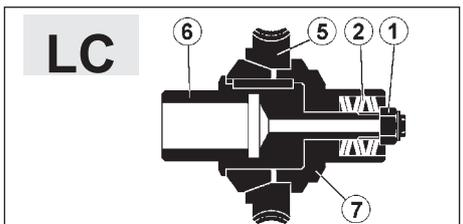
Consultando las figuras, la transmisión del movimiento se produce por fricción entre las superficies del eje (6) de la rueda helicoidal dentada (5) y del casquillo (7) que se someten a una determinada compresión (regulable) a través de la acción ejercida en las arandelas de muelles (2) por la tuerca de regulación o por la corona (1).
