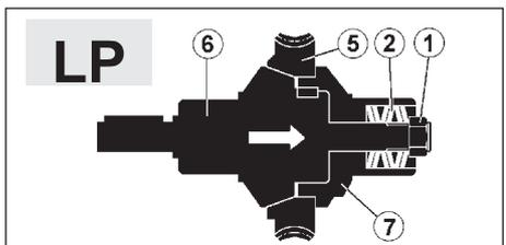
En se référant aux figures, la transmission du mouvement se fait par friction entre les surfaces de l'arbre (6) de la couronne dentée (5) et de la douille (7), qui sont soumises à une compression déterminée (réglable) à travers l'action exercée sur les ressorts Belleville (2) par l'écrou de réglage ou par la bague (1).
