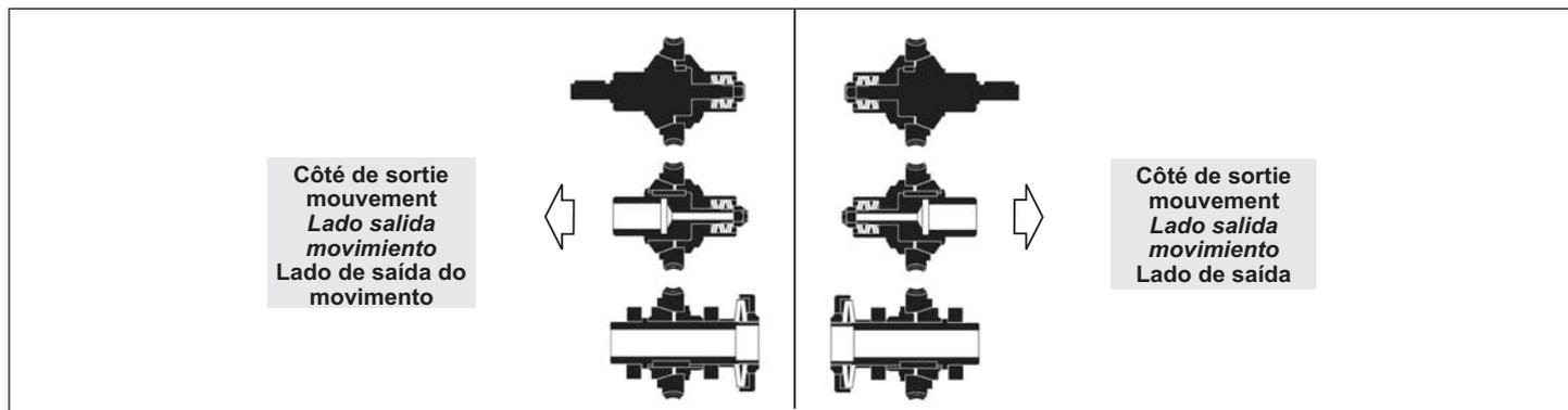
Il est très important de préciser aussi le côté où on souhaite la sortie du mouvement **A, B**, à l'aide des schémas aux pages **A 5-6-7-8-9**. Il est à noter que du côté opposé à la sortie il sera possible d'effectuer le calibrage du limiteur en agissant sur l'écrou ou sur la bague prévus à cet effet.
