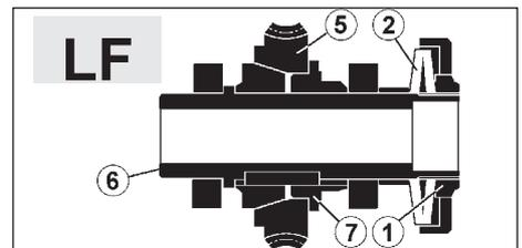
Consultando as figuras, a transmissão de movimento é feita pelo atrito entre as superfícies do eixo (6) da coroa dentada (5) e da bússola (7) que são submetidas a uma determinada compressão (regulável) por meio da ação exercida nas molas Belleville (2) pela porca de regulagem ou pela ponteira (1).
