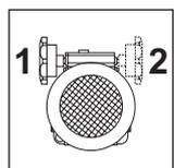
Quand le volant de commande est dans la position 1, l'indicateur a une échelle de lecture ANTI-HORAIRE.
