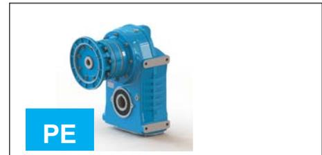
Le produit est obtenu en utilisant la série de réducteurs P, combinés en entrée avec un réducteur épicycloïdal à deux étages de réduction, obtenant ainsi un réducteur à 4 étages avec la perspective d'augmenter la disponibilité des rapports de réduction bien au-delà des limites du P et PL.
