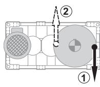
Dans le cas de levage avec tambour ayant une tension vers le bas il est préférable que le câble s'enroule du côté opposé au moteur (1).
