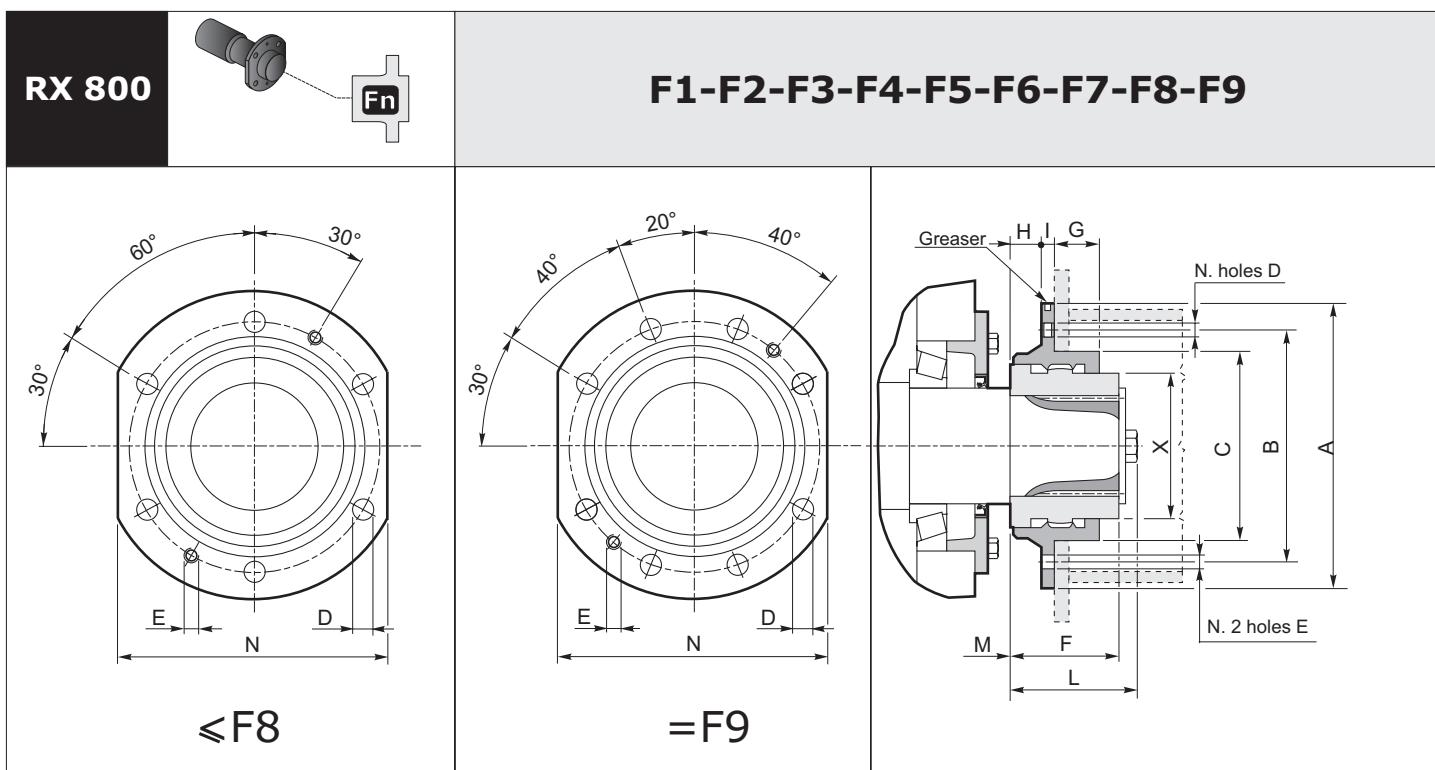
Accouplements réducteurs joints / Acoplamientos reductores uniones / Acoplamentos redutores com junções
