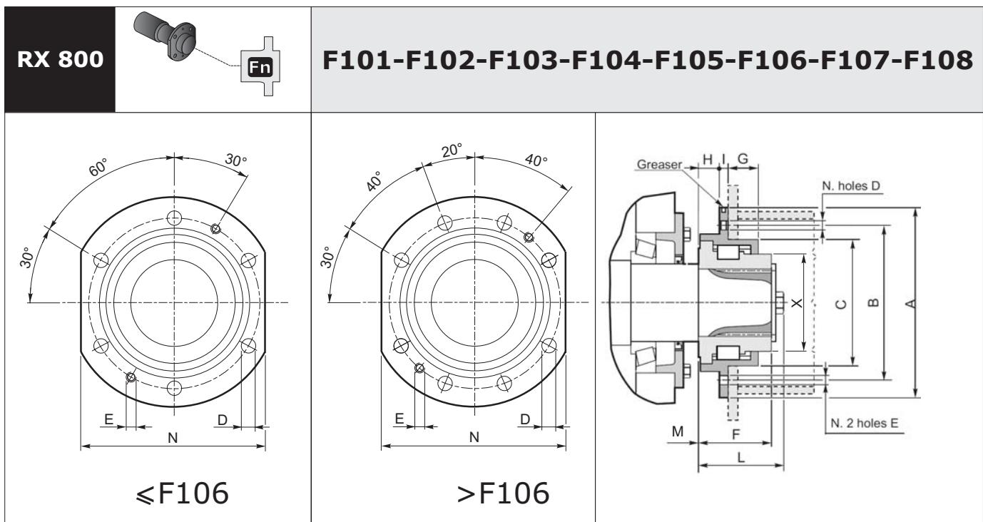
Accouplements réducteurs joints / Acoplamientos reductores uniones / Acoplamentos redutores com junções
